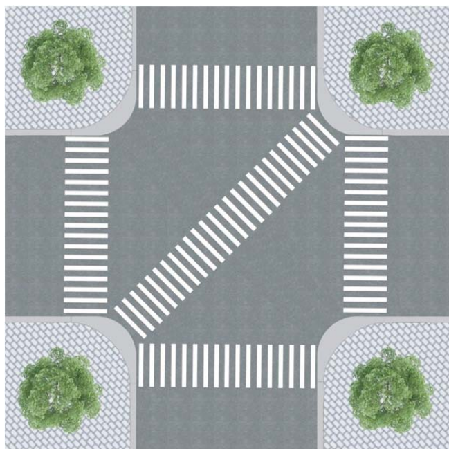
в – диагональный пешеходный переход с двух сторон перекрестка с использованием разметки 1.14.1
