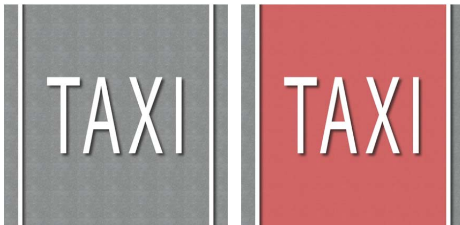
Рисунок 5.16 – Обозначение выделенной полосы для легкового такси разметкой 1.23.5д
