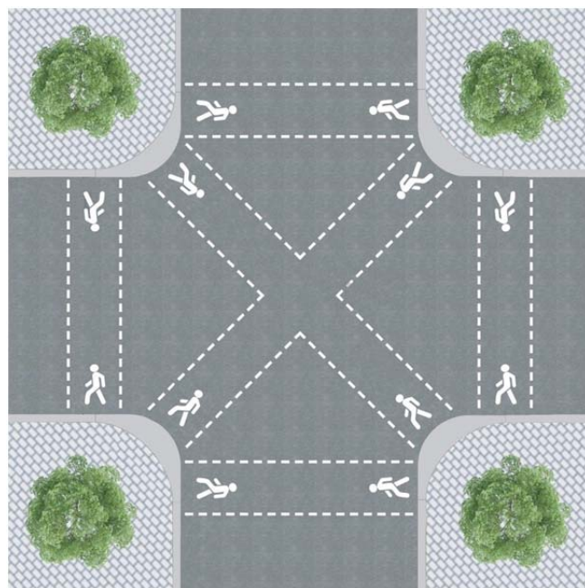
б – диагональный пешеходный переход со всех сторон перекрестка с использованием разметки 1.14.3д и 1.23.2д
