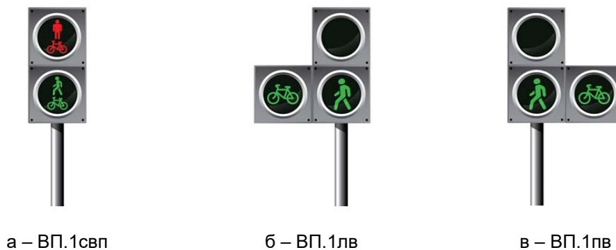
Рисунок 7.2 – Исполнение велопешеходных светофоров ВП.1
